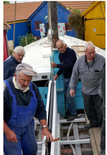
Après dépose du **puît de dérive** d'origine, fabriqué en résineux, dégradé par la pourriture, les charpentiers l'ont reconstruit en exotique, en soignant particulièrement les assemblages (tenon/mortaise + raidisseurs traversant) et l'étanchéité.
