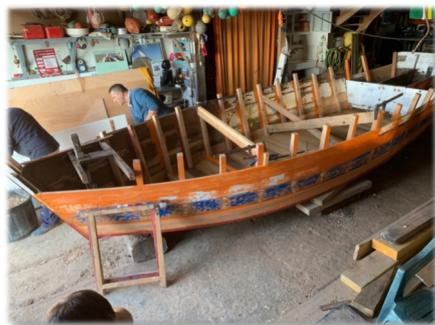
La sole totalement reconstruite, la quille remise en état et les nouvelles membrures posées, le bateau a été retourné mi-avril pour que les guérisseurs puissent attaquer les œuvres hautes. Quelques planches, quelques clous...
